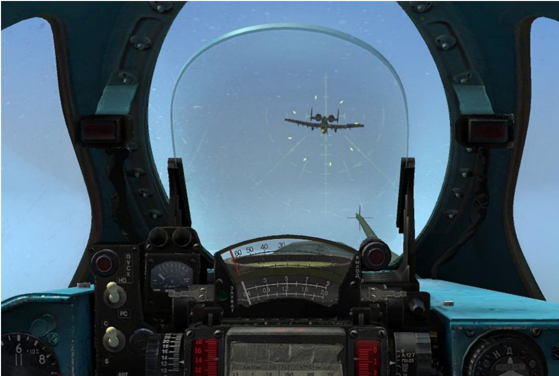
Image 10.15: Attaque au canon interne avec l'ASP en mode gyro automatique (distance fixe 300m).
