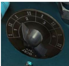
Image 9.2: Sélectionneur de fréquence ARC ou sélectionneur de secteur (RV37). Il y a quatre secteurs (1 - 4), chacun ayant deux sous-secteurs (I et II). Cela permet de stocker 72 stations ( 4 * 2 * 9 ).
