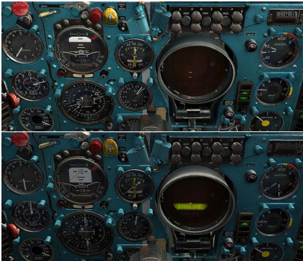
Image 9.12: L'image du haut montre l'avion à 71 km de la station RSN, en mode PERCÉE. Notez que l'avion est au dessus du plan de descente (barres de descente) alors que la vitesse verticale est proche de celle recommandée par l'aiguille de guidage (aiguille jaune sur le KPP). Sur l'image du bas, le même avion se trouve à 24 km de la station RSN, sur le plan de descente et descend actuellement à une vitesse verticale supérieure à celle recommandée.
