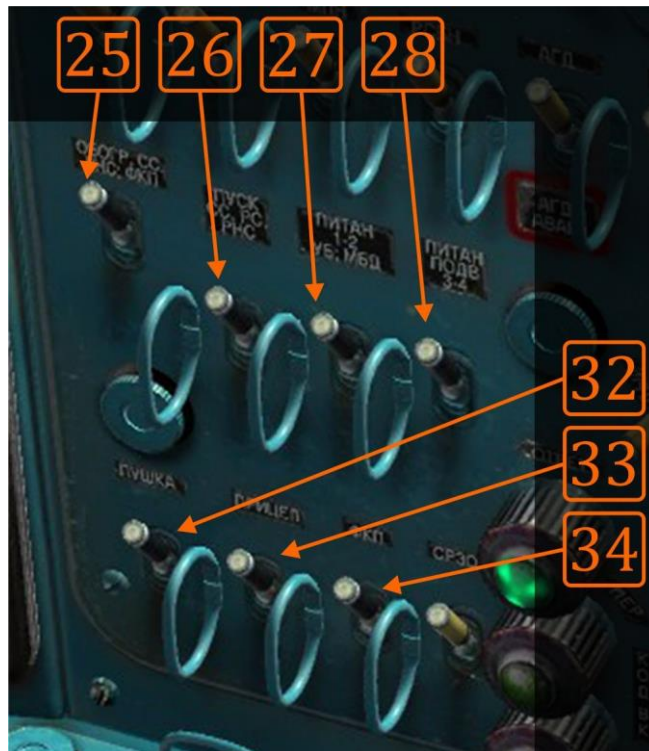
Image 10.1: Interface d'activation des armes sur le panneau vertical droit.
