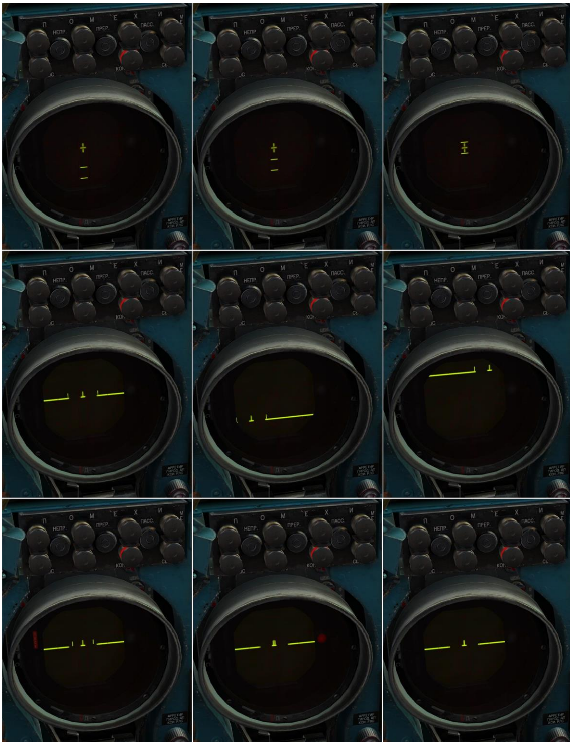
Image 10.7: illustration de l'autotest du radar
