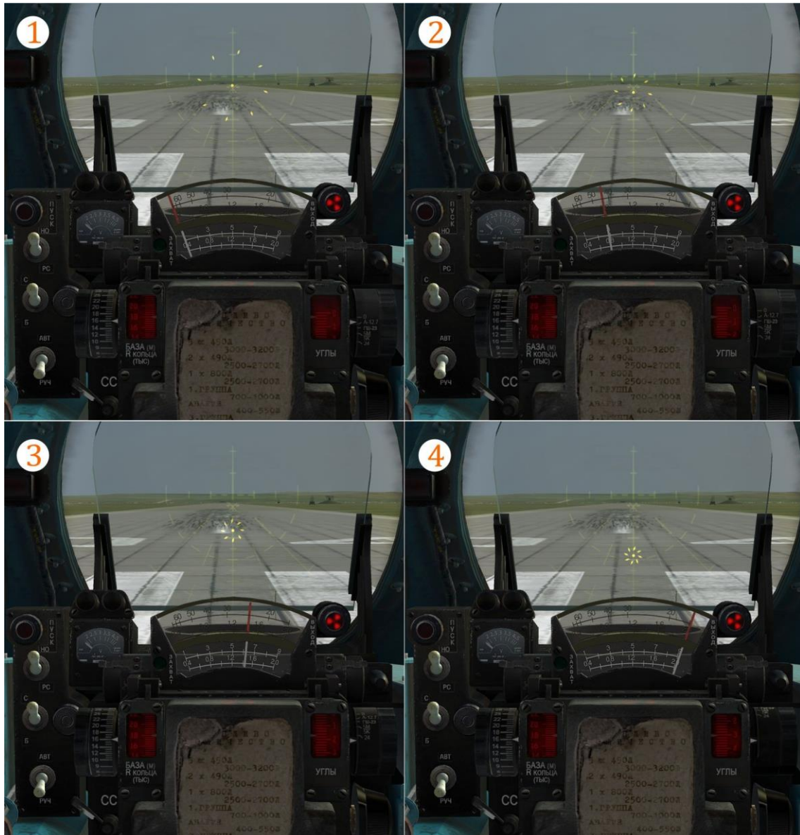
Image 10.5: Illustration de la relation entre la distance (introduite par la poignée rotative), la taille du viseur et l'angle d'interception.
