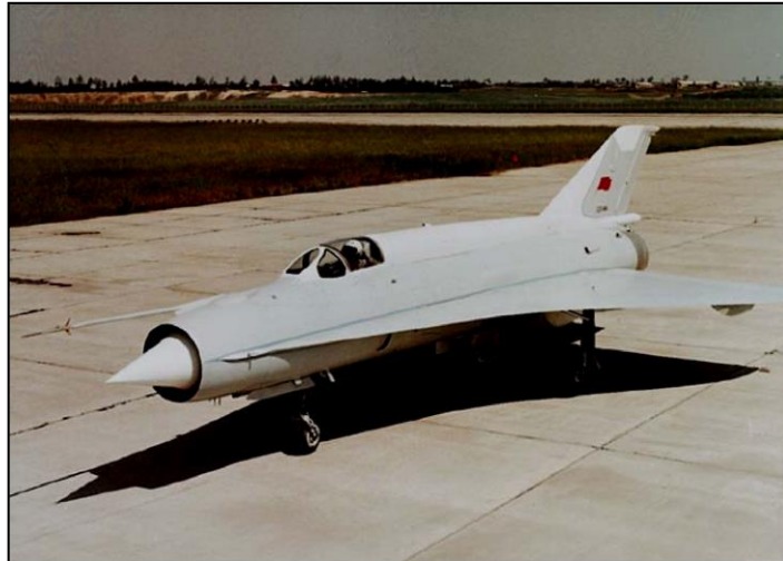
1961: MiG-21I "Analog", banc d'essai pour la recherche et le développement de l'aile de l'avion de ligne Tu-144.
