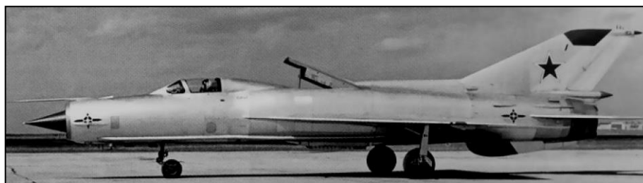
1966: MiG-21PD, avion expérimental à décollage et atterrissage courts pour le développement de moteur de sustentation de l'avion MiG-23PD.
